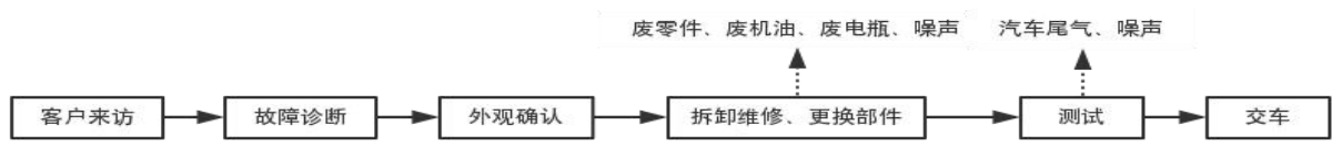
图 2-3 运营期汽车维修工艺流程及产污节点
